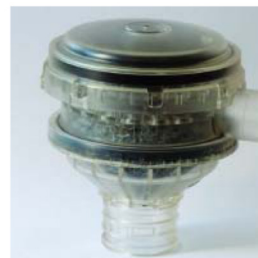
Aufbau Kurbelgehäuseentlüftung mit Ölnebelabscheider
