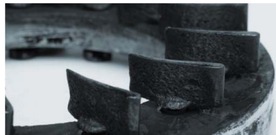
VTG: Starke Ölkohleablagerungen blockieren die Mechanik
